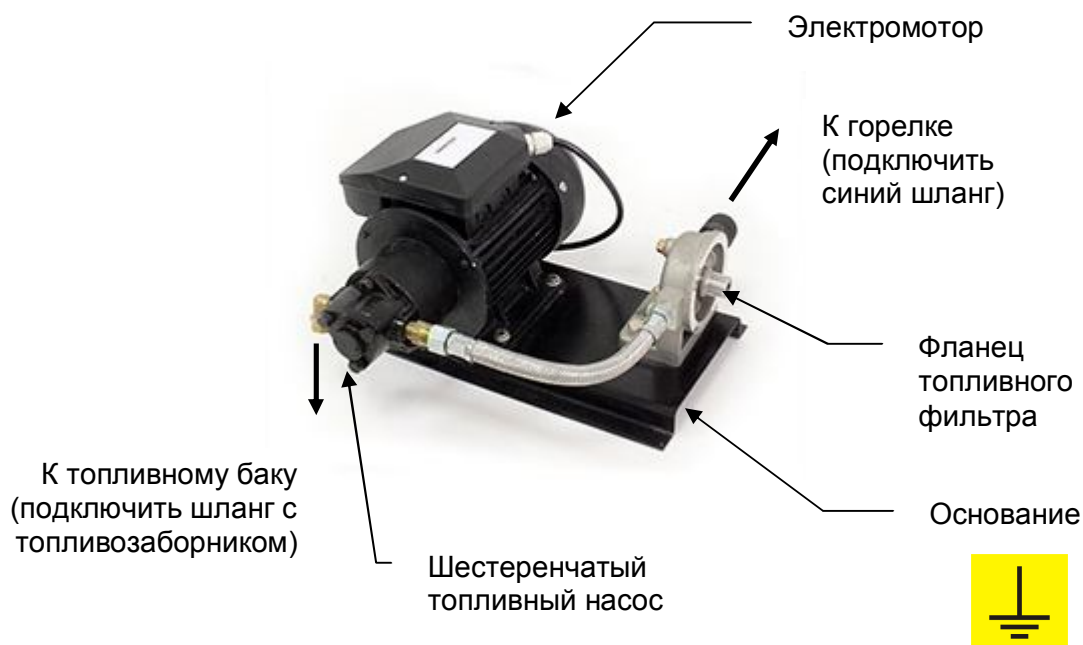
Рис. 12. Подъемный агрегат с фильтром тонкой очистки
